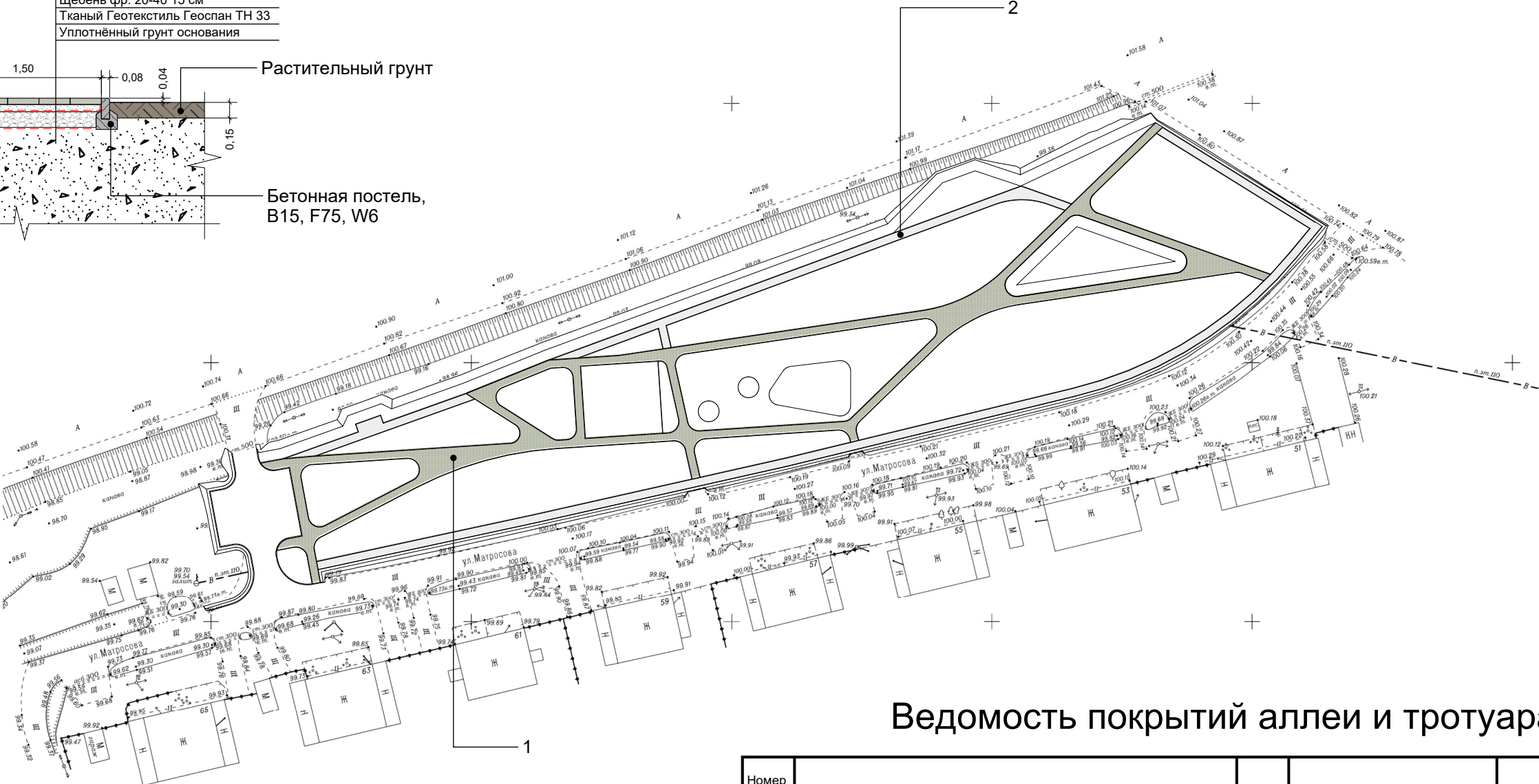
Конструкция тротуара. М 1:50
