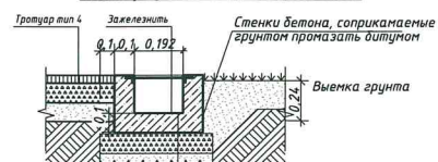
Деталь устройства водоотводного лотка
