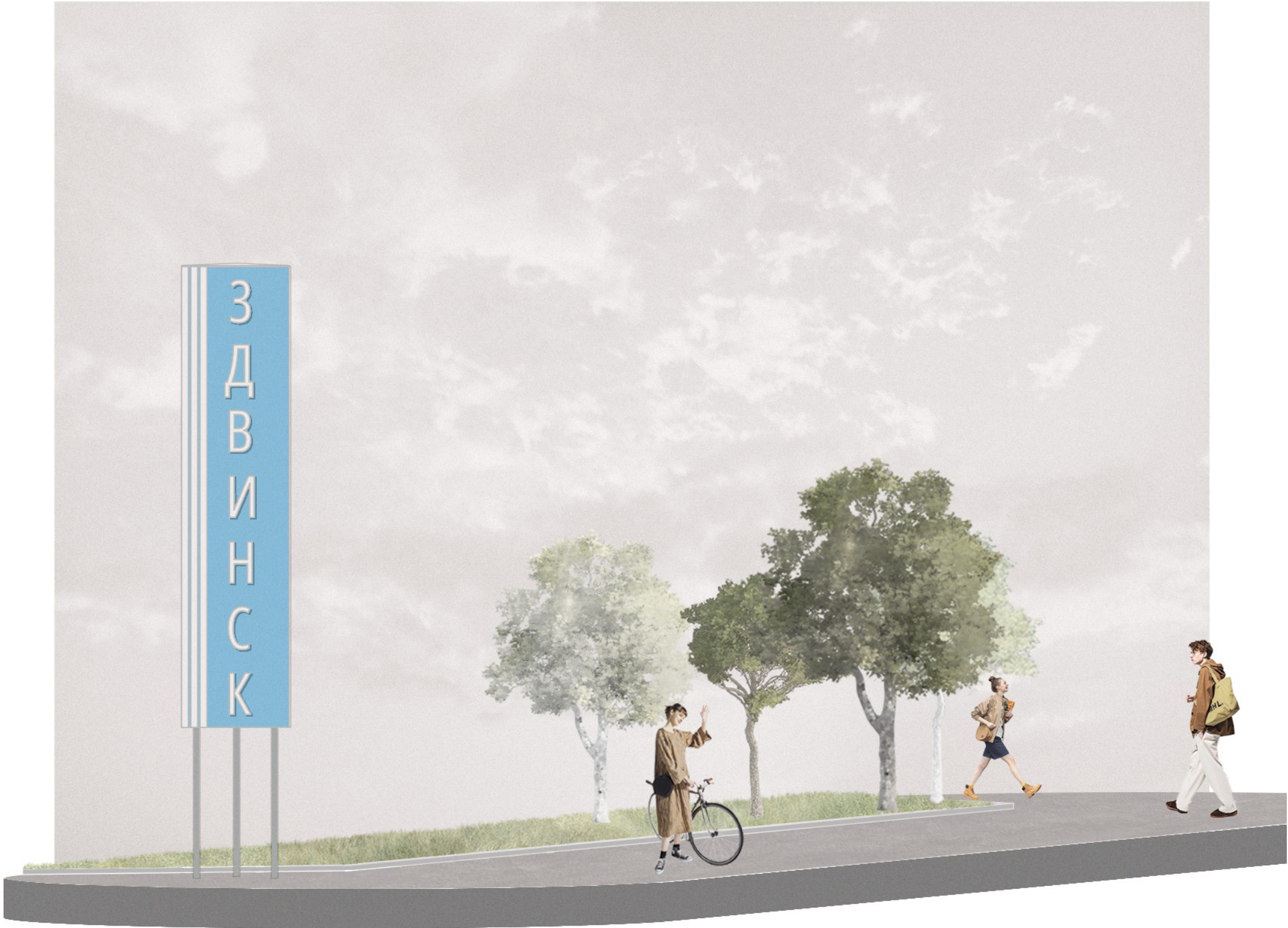
Конструкция стелы представляет собой металлический каркас, к которому крепятся фрагменты с буквами, а так же полосы которые могут светиться в ночное время. Название села расположено на фасадах стелы с трёх сторон.
