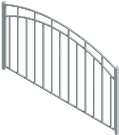
2 2. Секция ограждения тип 2 (2000 x 1200 мм) Столб ограждения (40 x 40 x 1000 мм)
