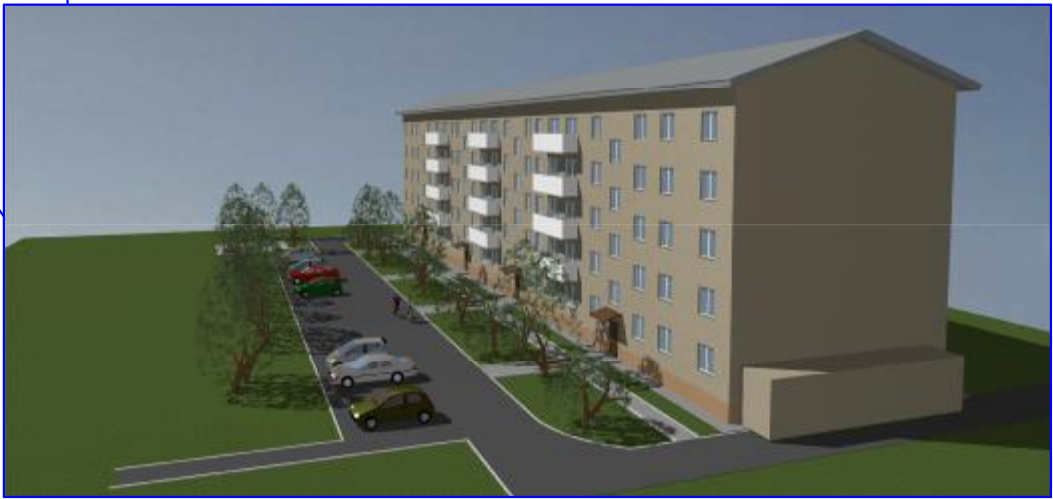
Устройство площадки для стоянки а/м 15м/м, с твердым а/б. покрытием.
